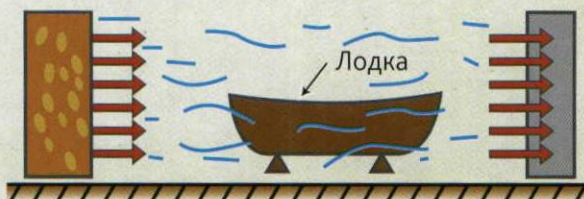
Рис. 3. Горизонтальный однонаправленный поток воздуха, или система воздухораспределения поршневого типа. Этот способ рекомендован для цехов по производству лодок из фиброгласа. Печатается по AIR-IX,1987, LVIS,1996.
