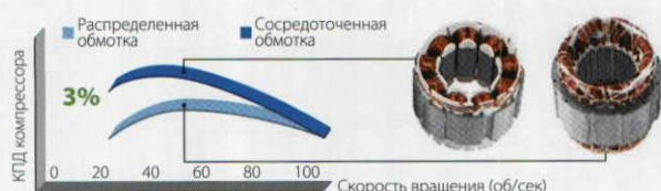
■ Рис. 3. Увеличение КПД за счет применения новых бесколлекторных электродвигателей
