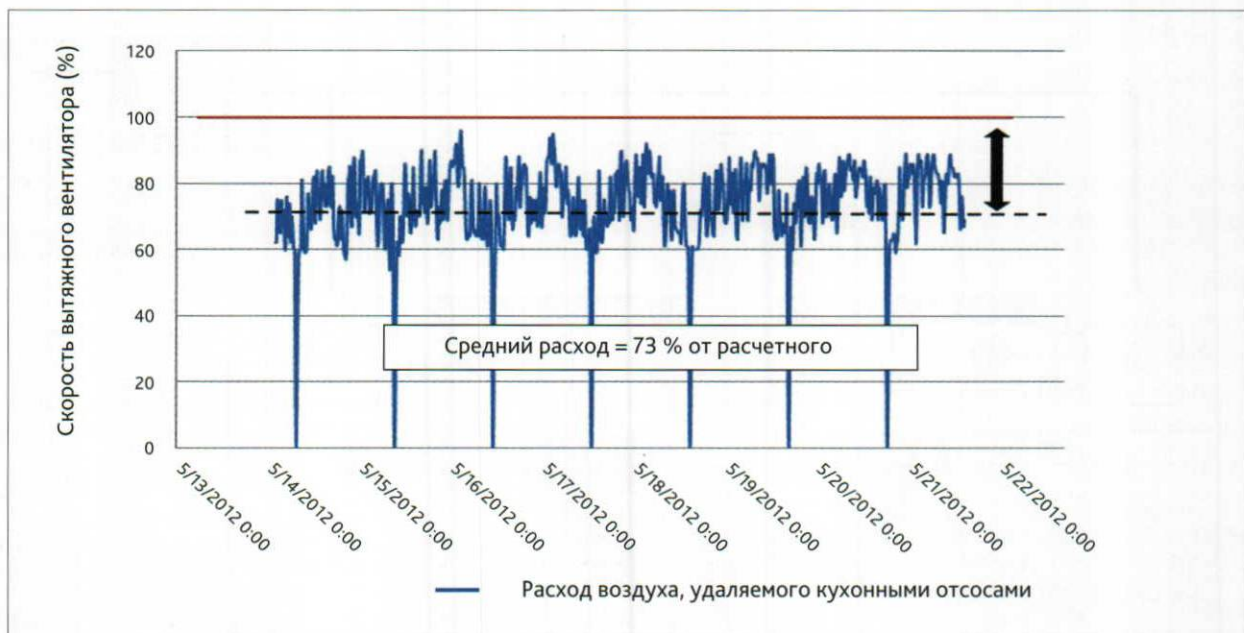
■ Рис. 6. Испытание установки с балансировочными клапанами
